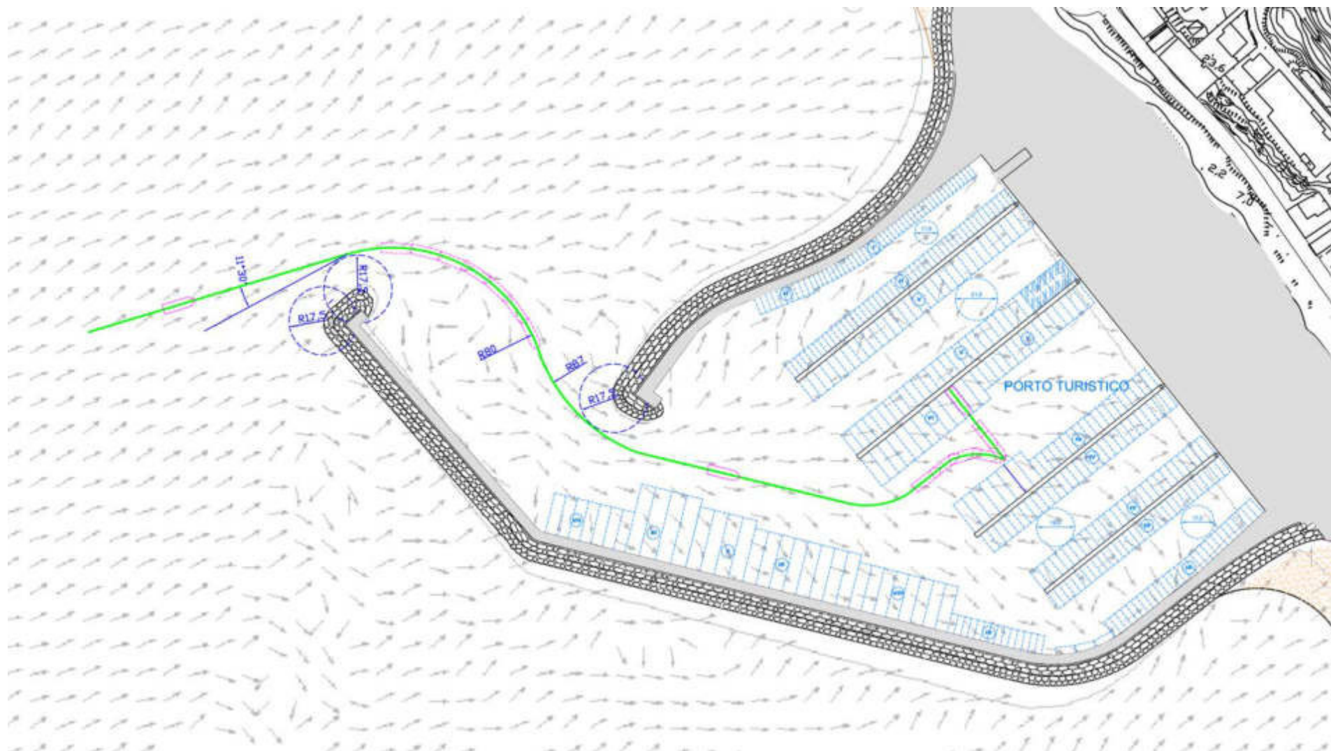
Figura 9.6 Tracciamento della rotta di entrata e manovre interne al porto con un clima d'onda sottocosta proveniente da 270°N
