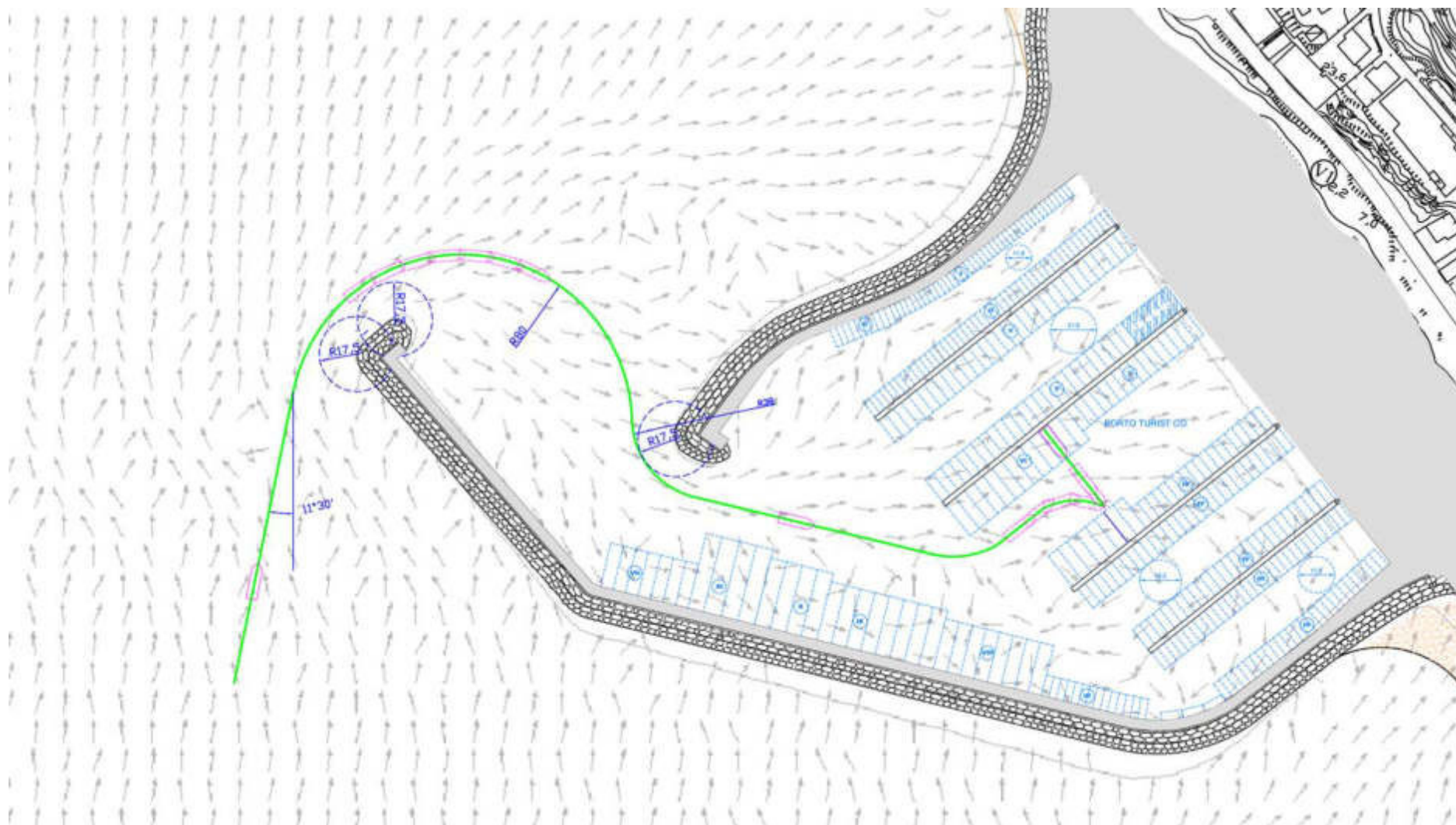
Figura 9.4 Tracciamento della rotta di entrata e manovre interne al porto con un clima d'onda sottocosta proveniente da 180°N
