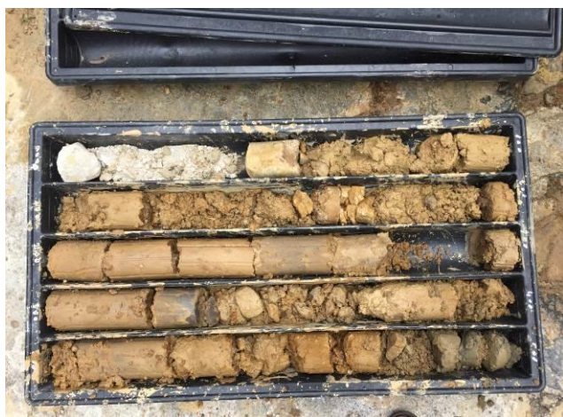
Stratigrafia sondaggio S1 da 0,00 -5,00 m dal p.c.
