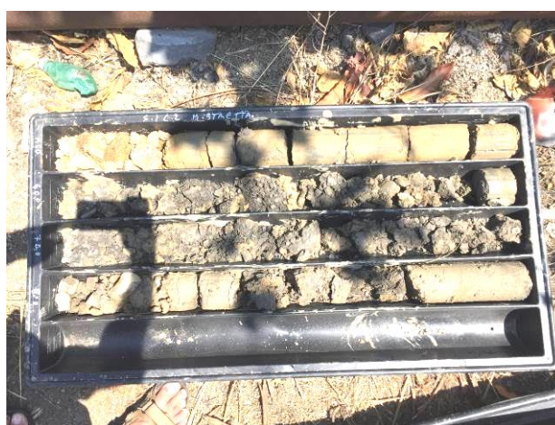
Stratigrafia sondaggio S1 da 5,00-10,00 m dal p.c.
