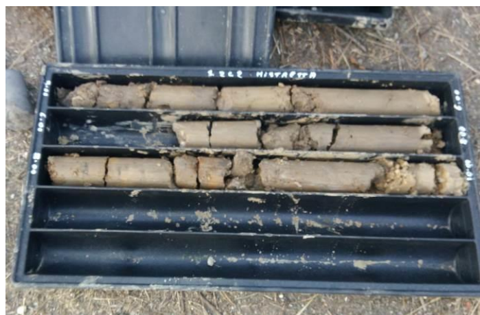
Stratigrafia sondaggio S2 da 5,00-10,00 m dal p.c.
