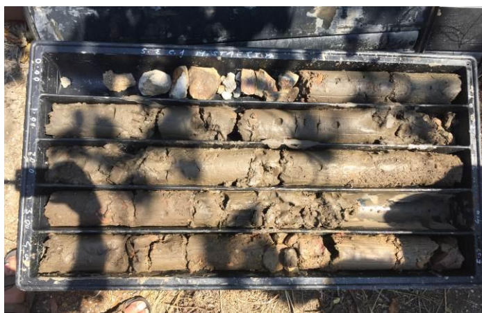
Stratigrafia sondaggio S2 da 0,00 -5,00 m dal p.c.
